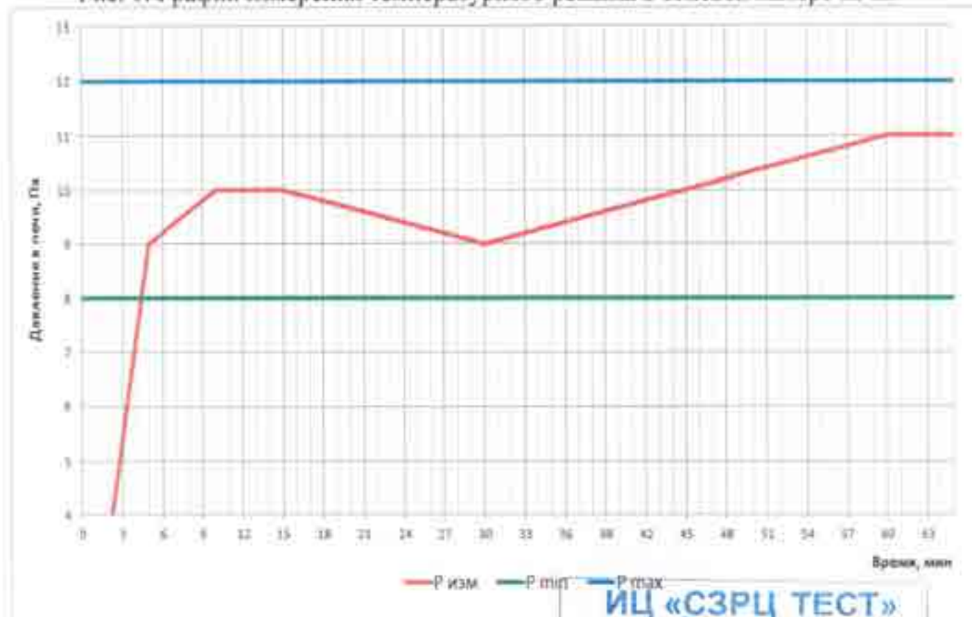
Рис. 2. График измерения избыточного давления в огневой камере печи.
