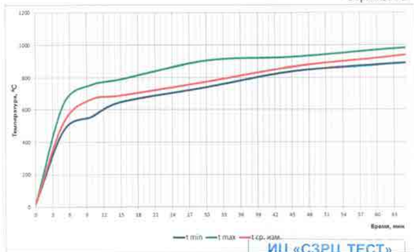
Рис. 4. График измерения температурного режима в огневой камере печи.
